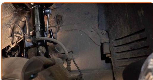
31 Montera och dra åt fästningarna till hjulbågsskyddet. Använd hylsnyckel Nr8. Använd en spärrnyckel.
