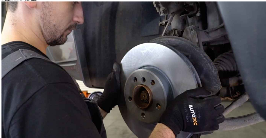
24 Dra åt bromsskivans fästelement. Använd Torx T30. Använd en momentnyckel. Dra åt den till 16 Nm vridmoment.
