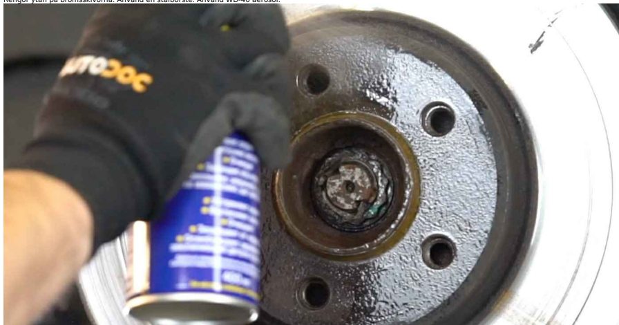
20 Skruva loss bromsskivans fästelement. Använd Torx T30. Använd en slagskrummejsel.
