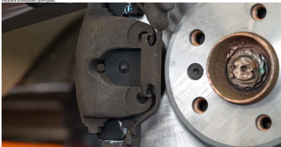
33 Rengör ytan på bromsskivorna. Använd brake cleaner.
