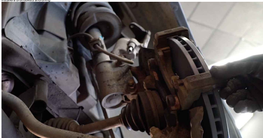
26 Dra åt bromsokets anordning. Använd hylsnyckel Nr16. Använd en momentnyckel. Dra åt den till 110 Nm vridmoment.
