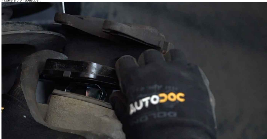
30 Installera bromsoket och justera den. Använd HEX Nr. H7. Använd en momentnyckel. Dra åt den till 30 Nm vridmoment.
