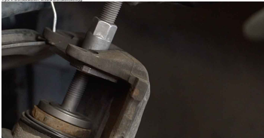
28 Rengör bromsokets monteringsåte och dess fäste. Använd en stålborste. Använd brake cleaner.
