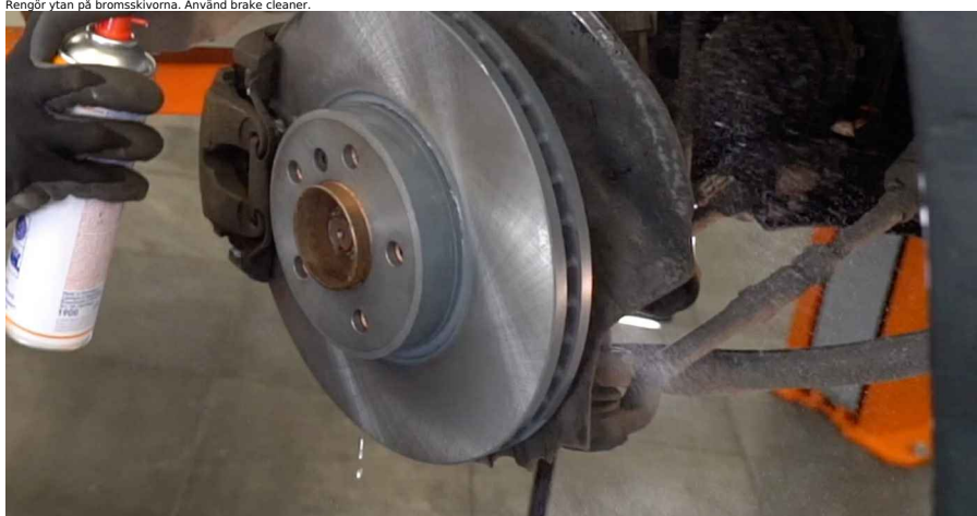
33 Rengör ytan på bromsskivorna. Använd brake cleaner.
