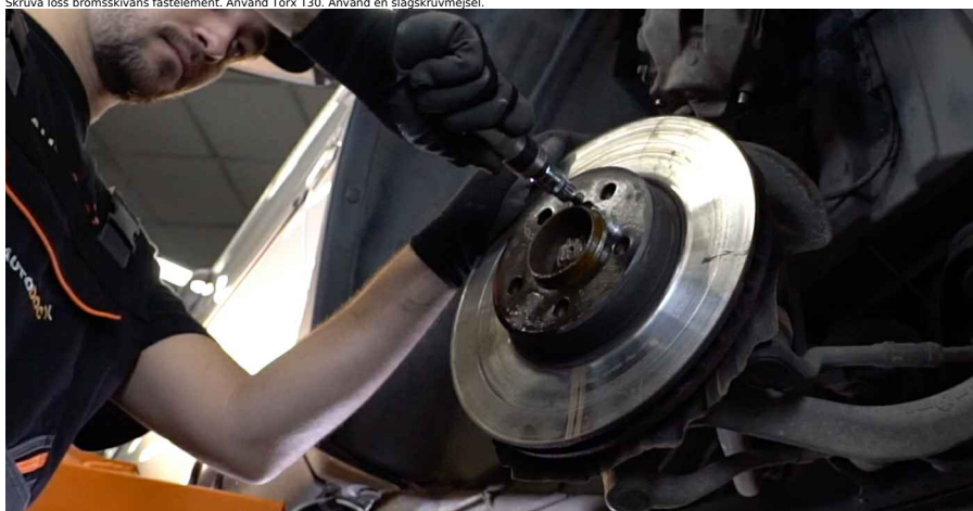
Utbyte: bromsskivor - BMW X5 E53. Tips: • Använd en gummihammare ifall det behövs.
