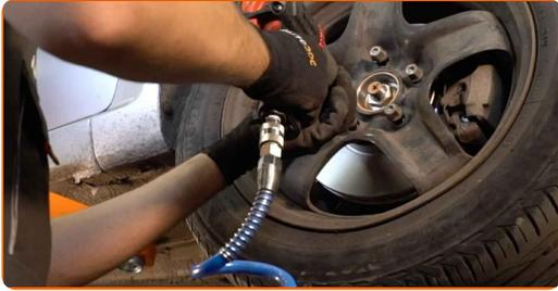
**35** Sänk bilen och arbeta i omvänd ordning, dra åt hjulbultarna. Använd en momentnyckel. Dra åt den till 110 Nm vridmoment.
