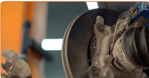
**16** Rengör fästningarna till bromsskivan. Använd en stålborste. Använd WD-40 aerosol.
