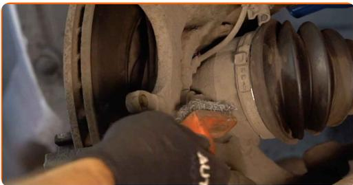
**14** Skruva loss fästelementen från bromsokets anordning. Använd hylsnyckel Nr18. Använd en trycknyckel.
