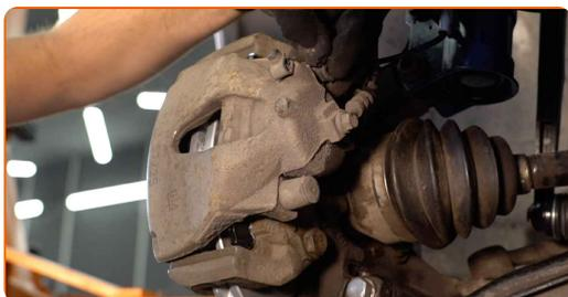
30 Sätt tillbaka bromsskyddsfjädern till original positionen. Använd en kofot.
