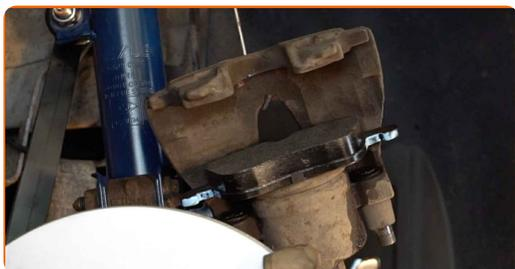
28 Installera bromsoket och justera den. Använd HEX Nr. H7. Använd en momentnyckel. Dra åt den till 28 Nm vridmoment.
