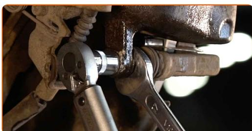
**33** Behandla bromsslängen. Använd brake cleaner.
