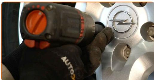
**48** Sänk bilen och arbeta i omvänd ordning, dra åt hjulbultarna. Använd en momentnyckel. Dra åt den till 110 Nm vridmoment.
