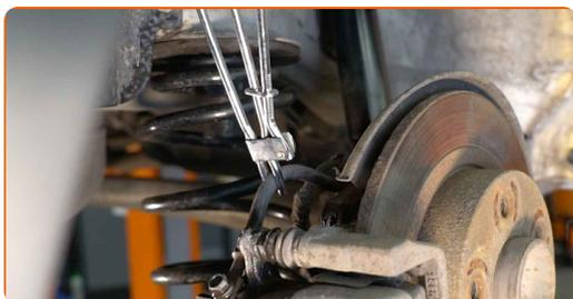
**10** Skruva loss bromsslagen från bromsoket. Använd kombinyckel Nr 11.
