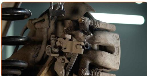
**12** Skruva loss bromsokets fästelement. Använd kombinyckel Nr 13.
